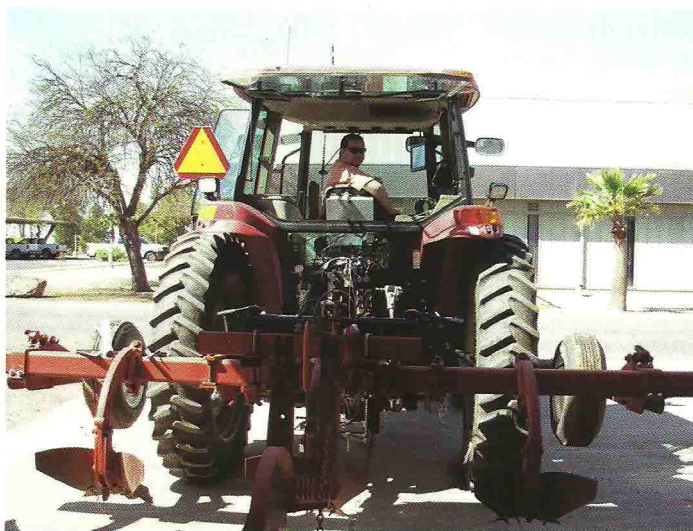
Figura 3- Sinalização traseira de tratores agrícolas para movimentação em rodovias.
