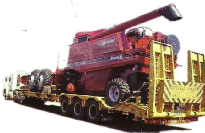
Figura 7- Transporte de colhedoras embarcadas em caminhões.
