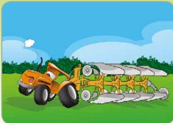
R – MITO! A carga a ser tracionada deve ser adequada a potência do trator. É importante que o operador saiba dimensionar, pois o excesso de carga pode ocasionar acidentes graves devido à perda de controle, principalmente em declives ou aclives.
