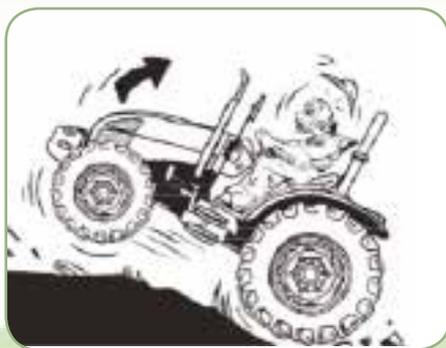
Arranque lentamente e aumente a velocidade gradualmente, o uso impróprio da embreagem pode causar o capotamento do trator
