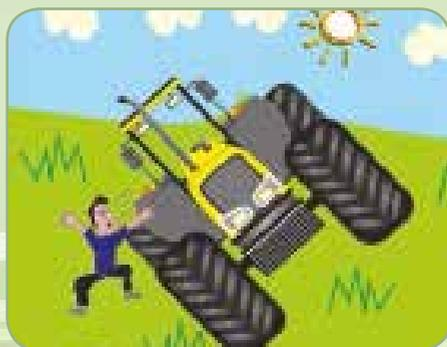
6. Em caso de tombamento, não pule se o trator for equipado com Estrutura de Proteção ao Capotamento e use o cinto de segurança.
