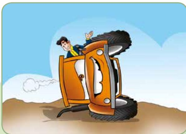
R - MITO! A estrutura de proteção ao capotamento tem como função garantir a integridade física do condutor. Para que isso ocorra, é imprescindível que o operador esteja utilizando o cinto de segurança e que siga a recomendação de segurar firme no volante e somente sair após a parada total do trator. Jamais tentar pular da máquina.
