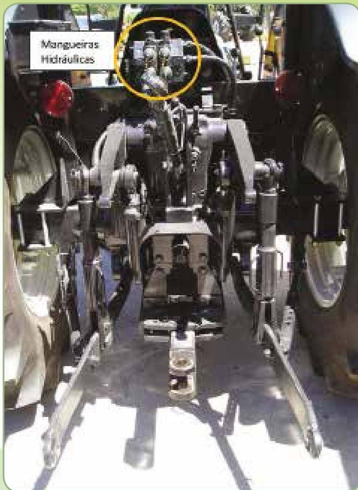
01. Antes de ligar ou desligar as mangueiras hidráulicas, pare o motor do trator e alivie a pressão do circuito acionando as alavancas do comando totalmente.
