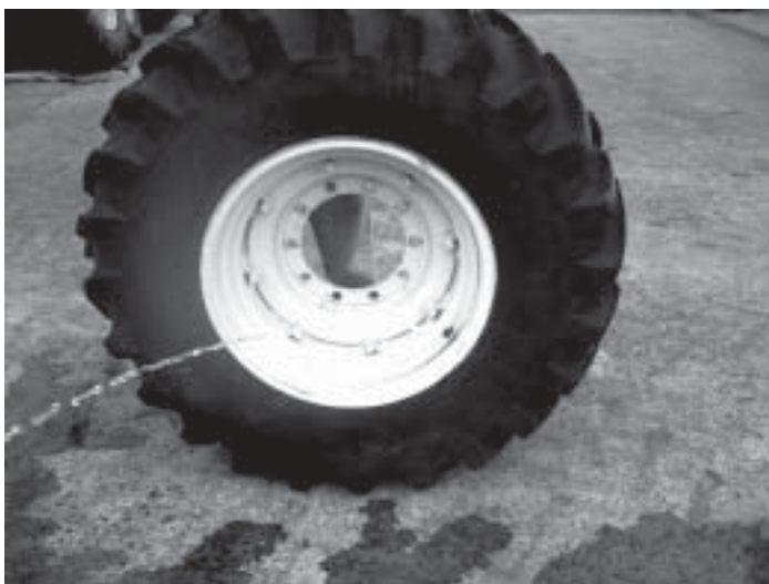
Bico a 45^{\circ} na Parte Inferior Adição de 40 % de Água no Pneu
