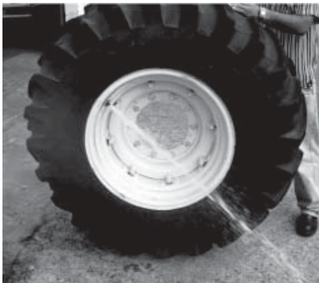
Bico a 45^{\circ} na Parte Superior Adição de 60 % de Água no Pneu
