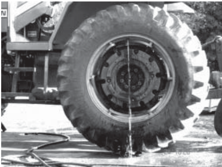
Bico a 90^{\circ} em Relação ao Solo Adição de 75 % de Água no Pneu
