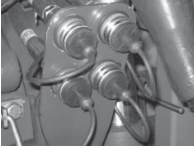
Válvulas de Controle Remoto
