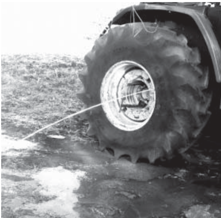
Bico na Posição Mediana Adição de 50 % de Água no Pneu
