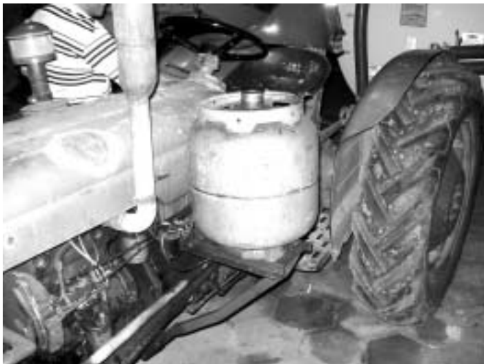
Tanque de combustível improvisado
