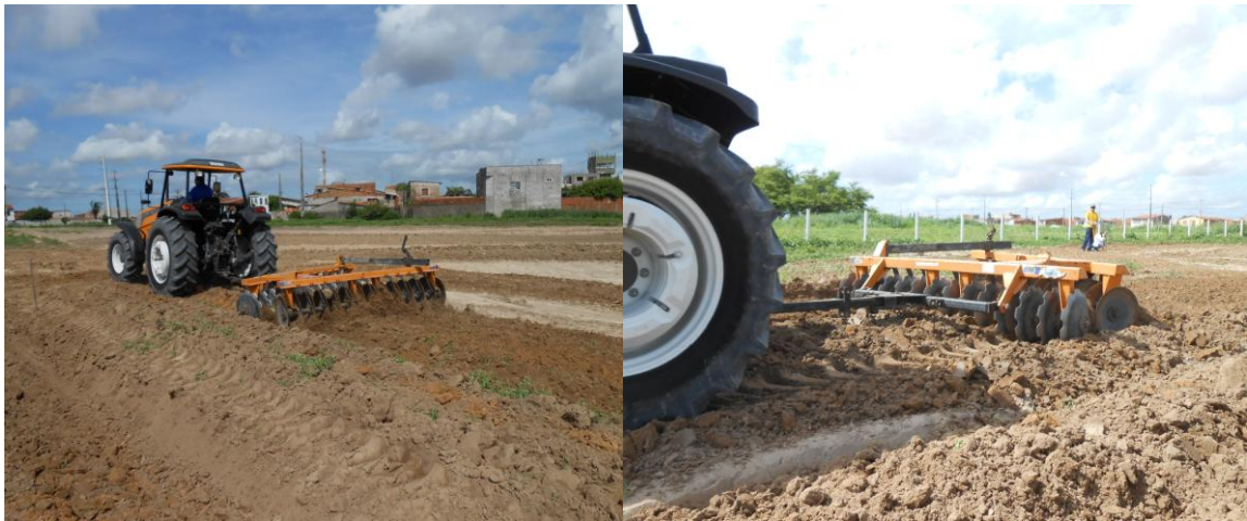
Figura 3 – Grade MARCHESAN, modelo GN, Off-Set, acoplado ao trator 4x2 TDA, modelo VALTRA BM125i.
