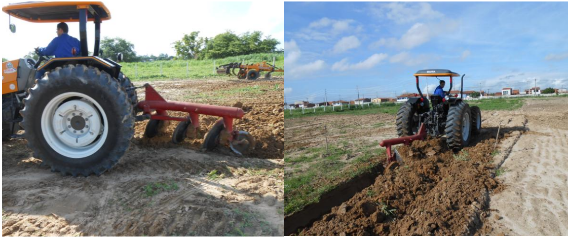
Figura 2 – Arado de disco fixo, acoplado ao trator 4x2 TDA, modelo VALTRA A950.
