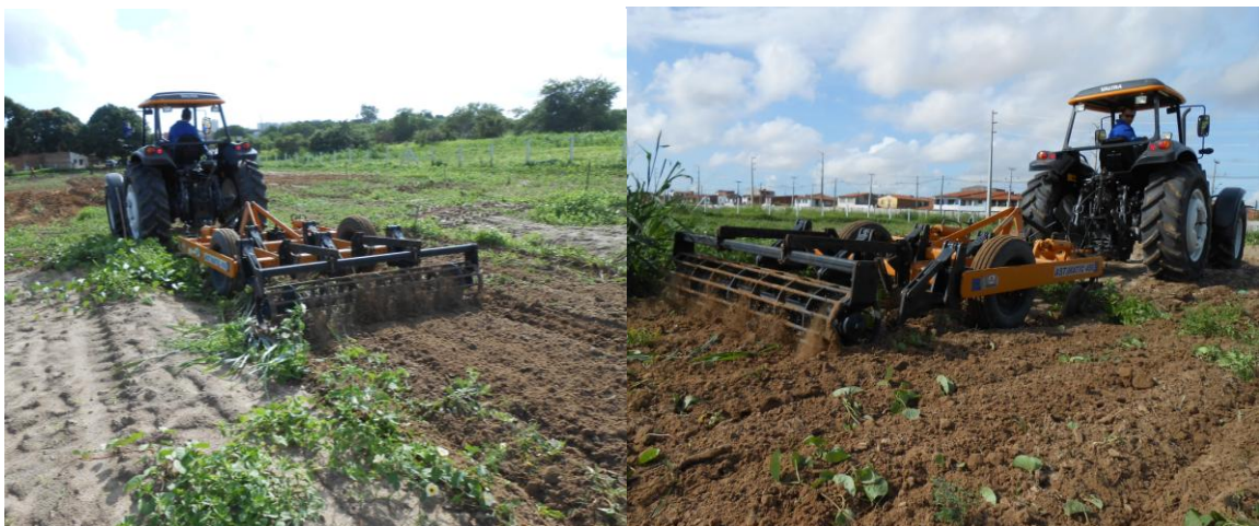
Figura 4 – Escarificador MARCHESAN, modelo AST/MATIC 450, acoplado ao trator 4x2 TDA, modelo VALTRA BM125i.
