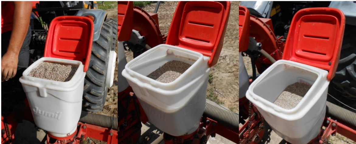
Figura 6 – Variação da carga no depósito de fertilizantes da semeadora.
