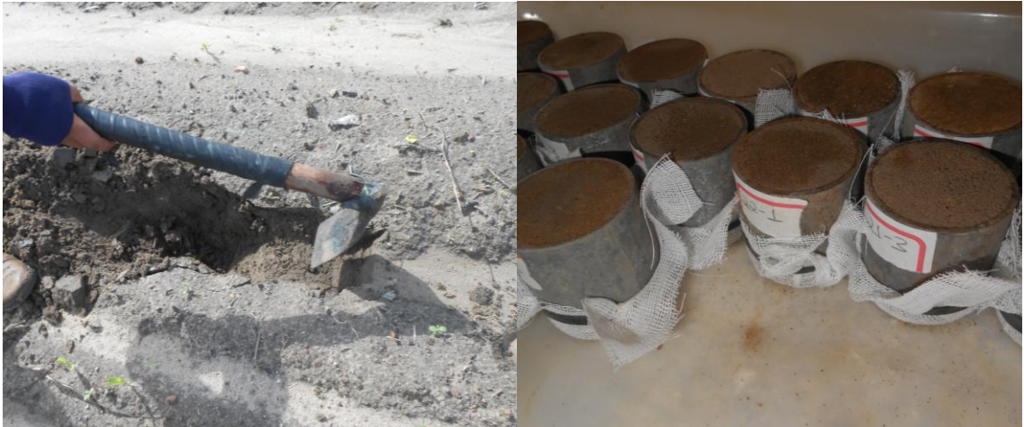
Figura 7 – Coleta das amostras de monólitos indeformados.
