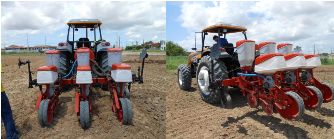
Figura 5 – Semeadora adubadora Jumil, modelo JM2090 PD, acoplada ao trator 4x2 TDA, modelo VALTRA BM120.
