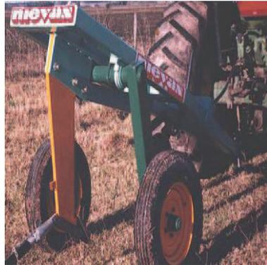
**Figura 31:** Haste parabólica.
